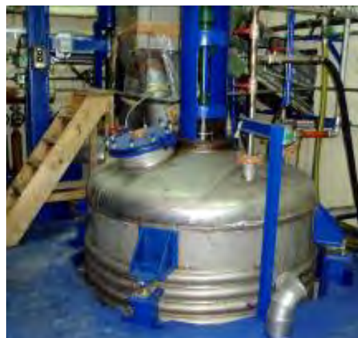
Slika 5. Reaktori za sintezu herbicida (HR-1/HR-2)
