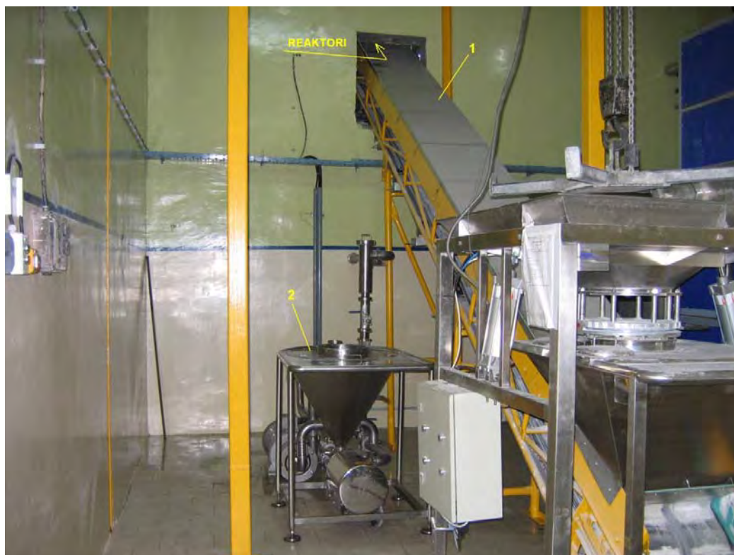
Slika 2. Uređaji za doziranje sirovina u zatvorenom sistemu
