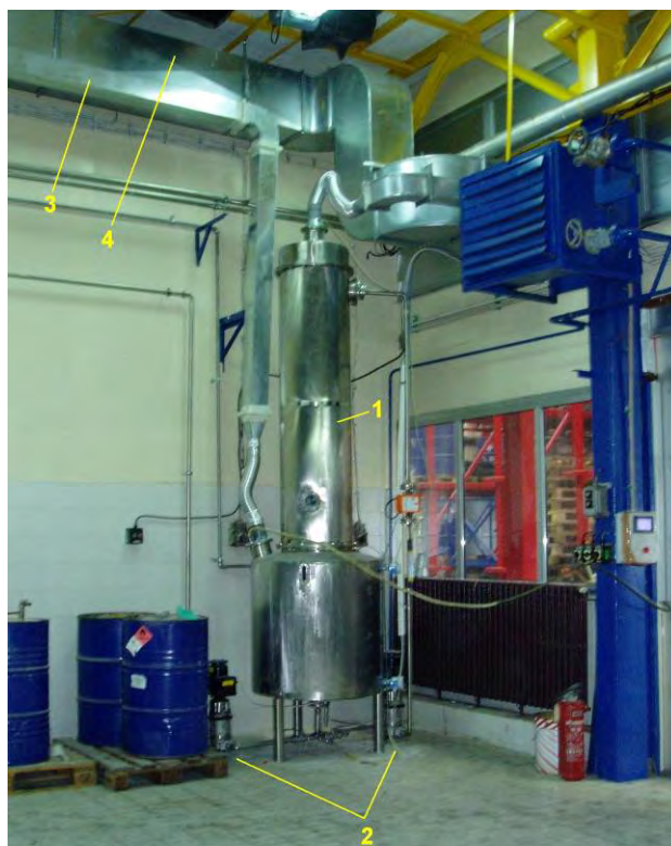
Slika 4. Deo opreme za prečišćavanje emisijih gasova: 1-Skruber SK-10, 2-cirkulacione pumpe
