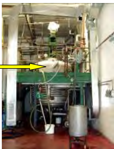
Slika 5. Reaktori za sintezu herbicida (HR-1/HR-2)
