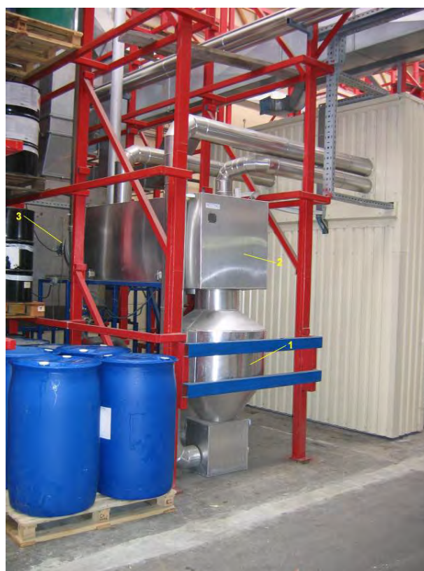
Slika 6. Deo opreme za prečišćavanje emisijih gasova
