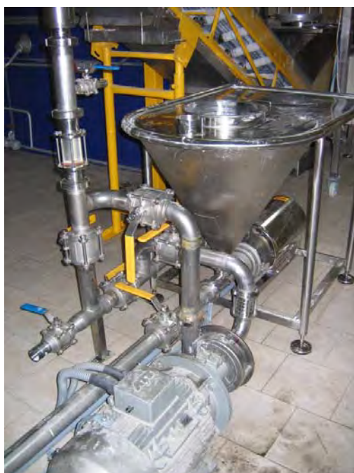
Slika 3. Uređaj za formiranje vodenih suspenzija
