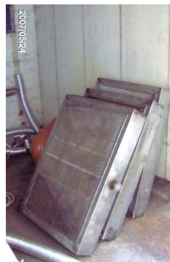
Slika 6. Kasete K1 sa aktivnim ugljem
